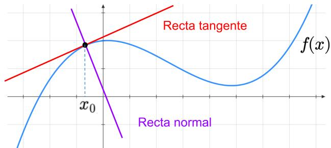
La **recta normal** en un punto  $x_0$  es una recta **perpendicular** a la **recta tangente** en dicho punto.
